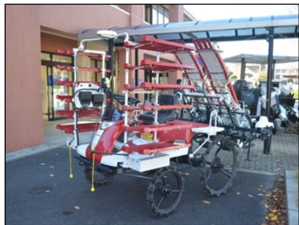
図 18 直進アシスト付全自動野菜移植機
