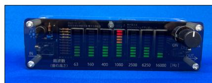
図2 工作物外観。工作物に対して発声した際の分析結果。1 kHzを中心とした強度分布が確認できる。
