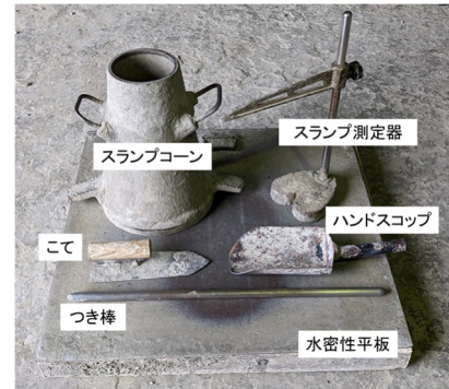
図1 スランプ試験器具一式
